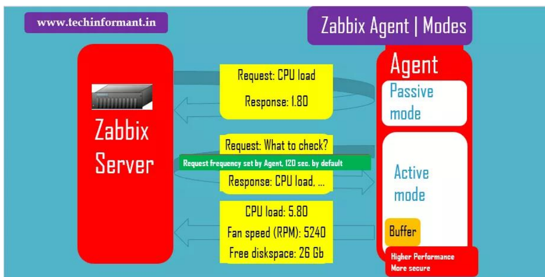
Figura 11 - Modos de coleta do Zabbix
