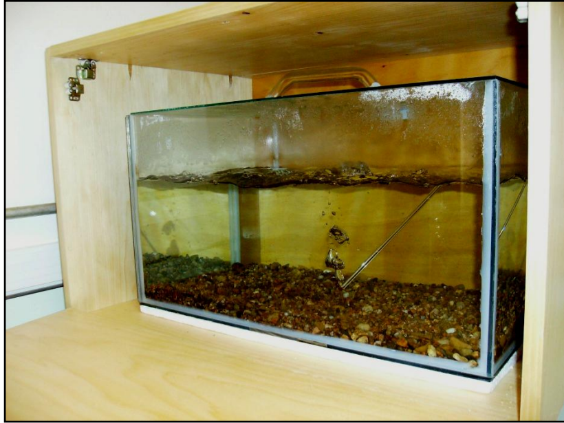
Figura 11. Cultura de bactérias aeróbias heterotróficas utilizadas para o Teste de Dissimilação.
