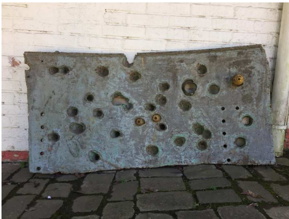
Figura 15 - Parte da couraça de um tanque de guerra, para testes balísticos.
