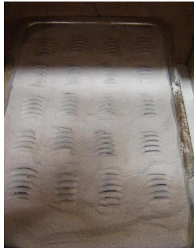
Figura 4.2: Molas acondicionadas em leito de alumina A-1000 SG para remoção de ligantes por wicking .
