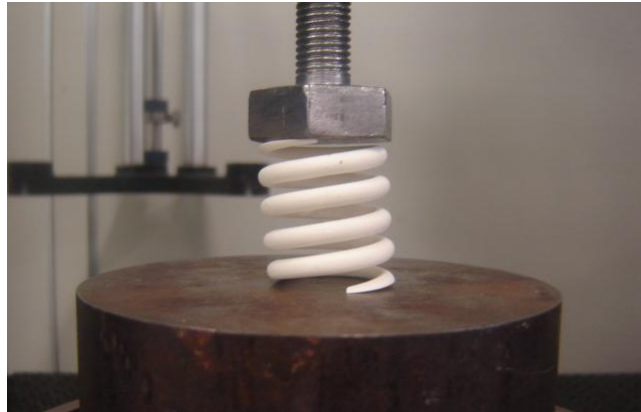
Figura 4.5: Mola apoiada nas extremidades para ensaio de compressão.
