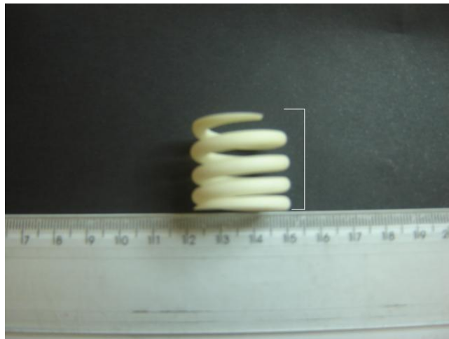
Figura 5.5: Espaçamento irregular das espiras promovido pela sinterização.
