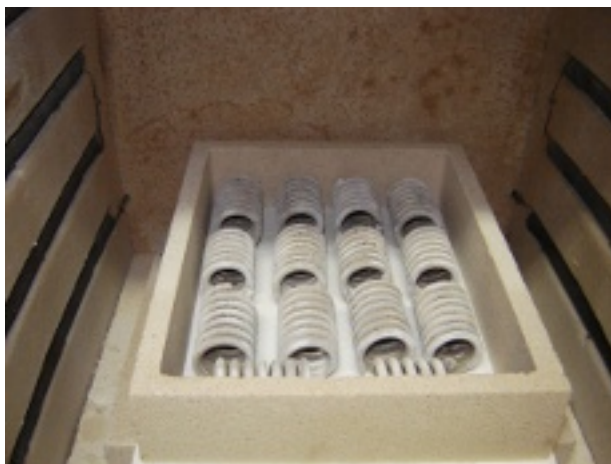
Figura 5.2: Molas com coloração escura, após extração de ligantes, devido a degradação parcial dos componentes orgânicos do ligante.
