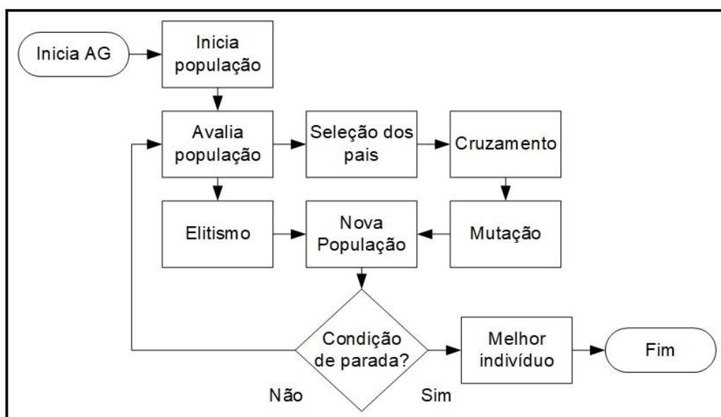
Figura 32 - Fluxograma do algoritmo genético
