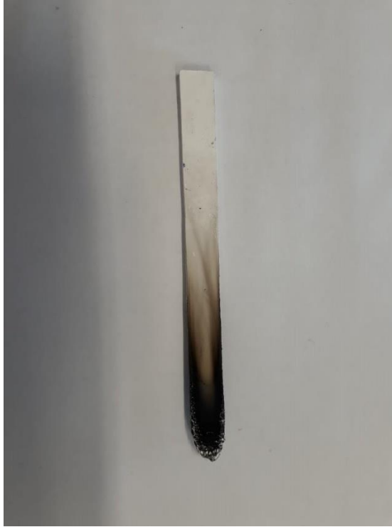
Figura 13 - Formação de char na amostra de PP/TiO 2
