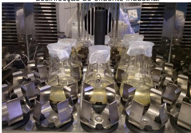
Figura 15 – Amostras dispostas na incubadora do tipo shaker antes do ensaio de desinfecção do efluente industrial
