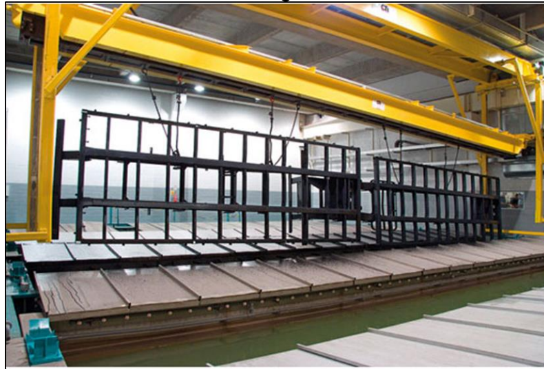
Figura 5 - Chassi sendo deslocado do tanque do desengraxe para o tanque do enxágue.
