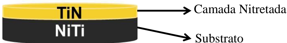
Figura 7: Esquema da estrutura das camadas nitretadas.
