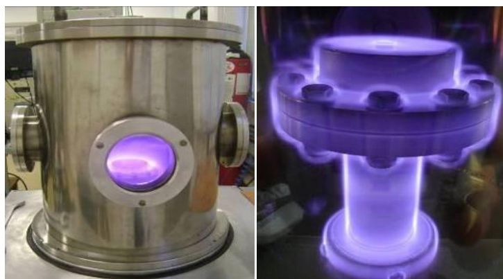
Figura 2217: Equipamento de oxidação a plasma no LESTT da UCS.
