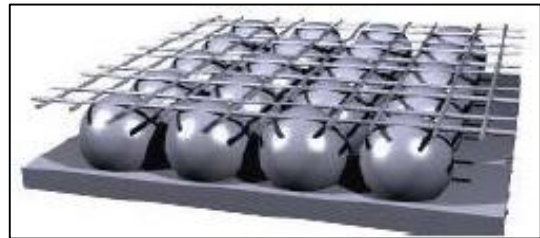
Figura 13 - Pré-laje (vista 3D)
