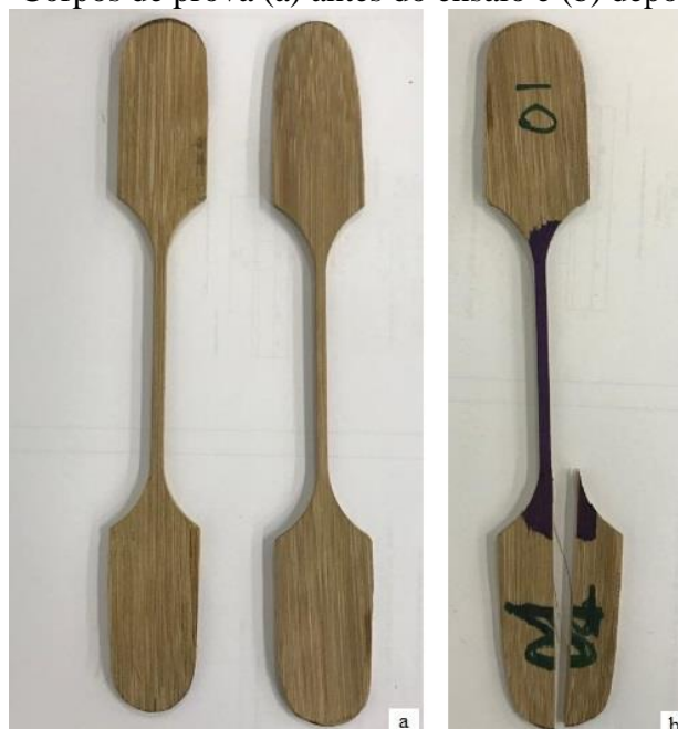
Figura 19 - Corpos de prova (a) antes do ensaio e (b) depois do ensaio
