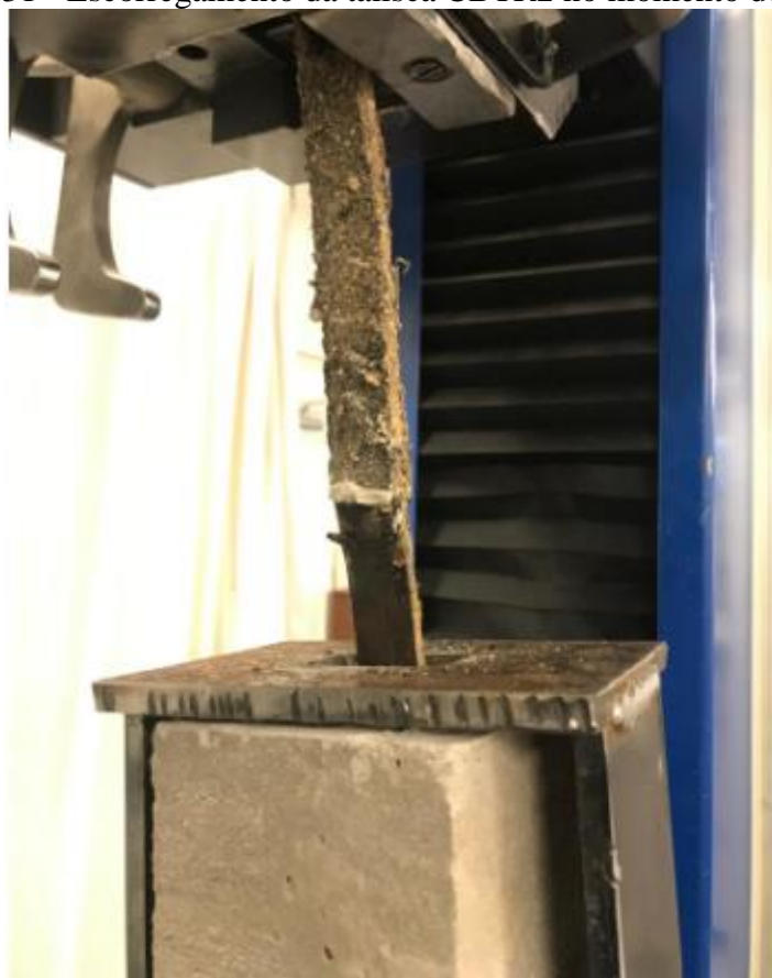
Figura 31 - Escorregamento da talisca CBTR2 no momento do ensaio
