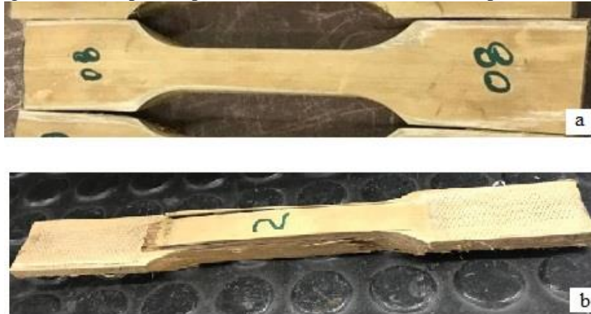
Figura 18 - Corpos de prova (a) antes do ensaio e (b) depois do ensaio
