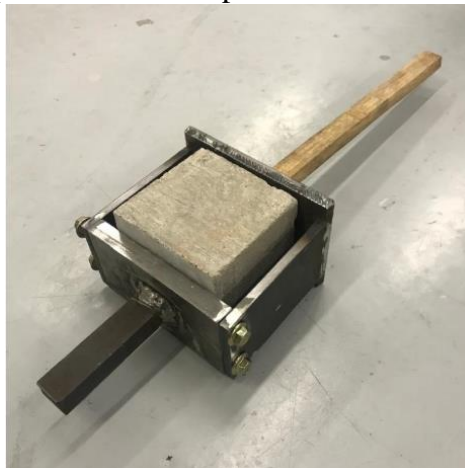
Figura 24 - Dispositivo metálico para auxiliar no ensaio de aderência
