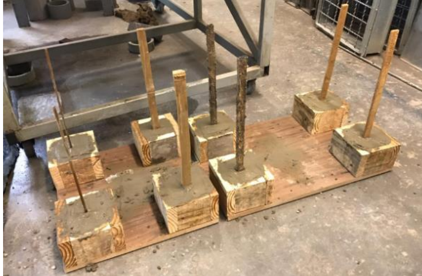
Figura 23 - Concretagem dos corpos de prova para o ensaio de aderência
