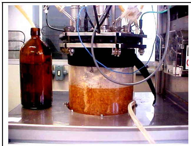
Figura 19- Biorreator de bancada no 8º dia de cultivo, mostrando a grande quantidade de biomassa formada.
