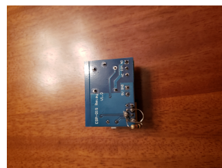
Figura 42: Soldagem do módulo relé
