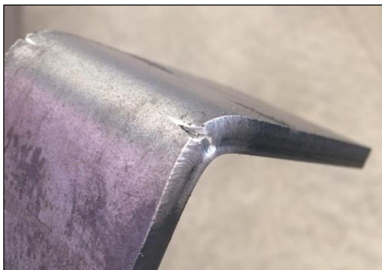
Figura 24 – Trincas no corpo de prova número 20
