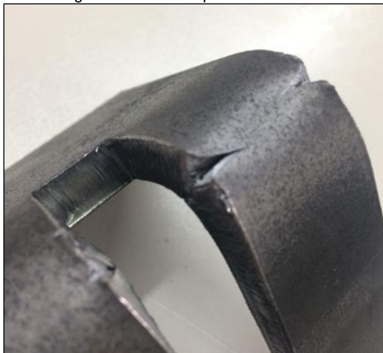
Figura 2 – Trincas após o dobramento
