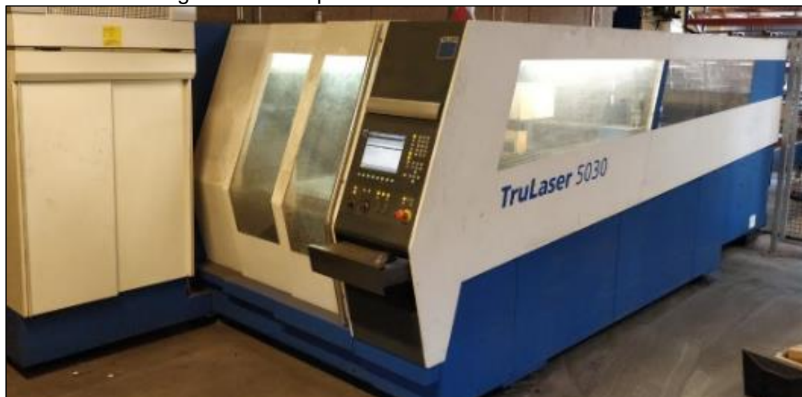
Figura 15 – Máquina de corte laser TruLaser 5030
