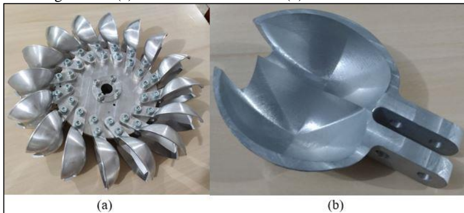
Figura 13 - (a) Rotor Pelton montado. (b) Pá do rotor usinada
