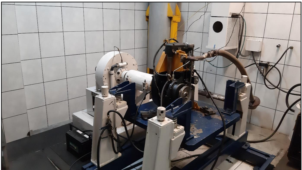
Figura 10 – Motor Agrale M93 montado no dinamômetro
