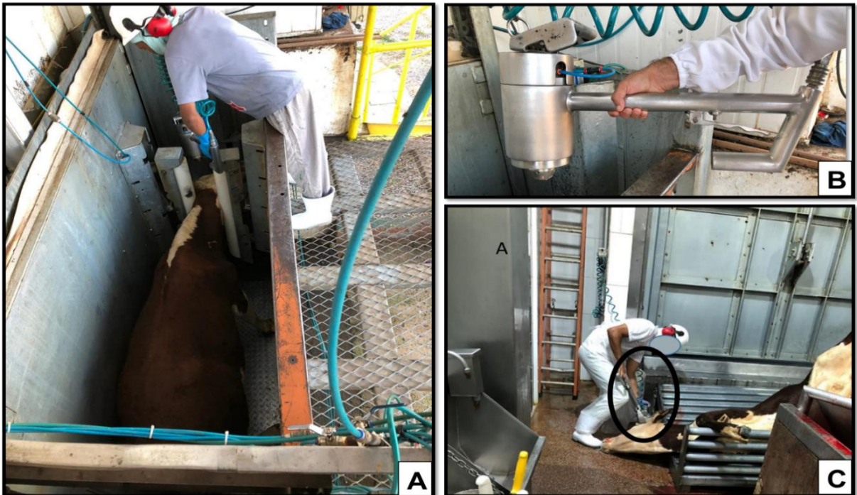
Anexo 4 - Box de atordoamento (A), pistola pneumática de dardo cativo (B), pistola de emergência próximo a praia de vômito (C).
