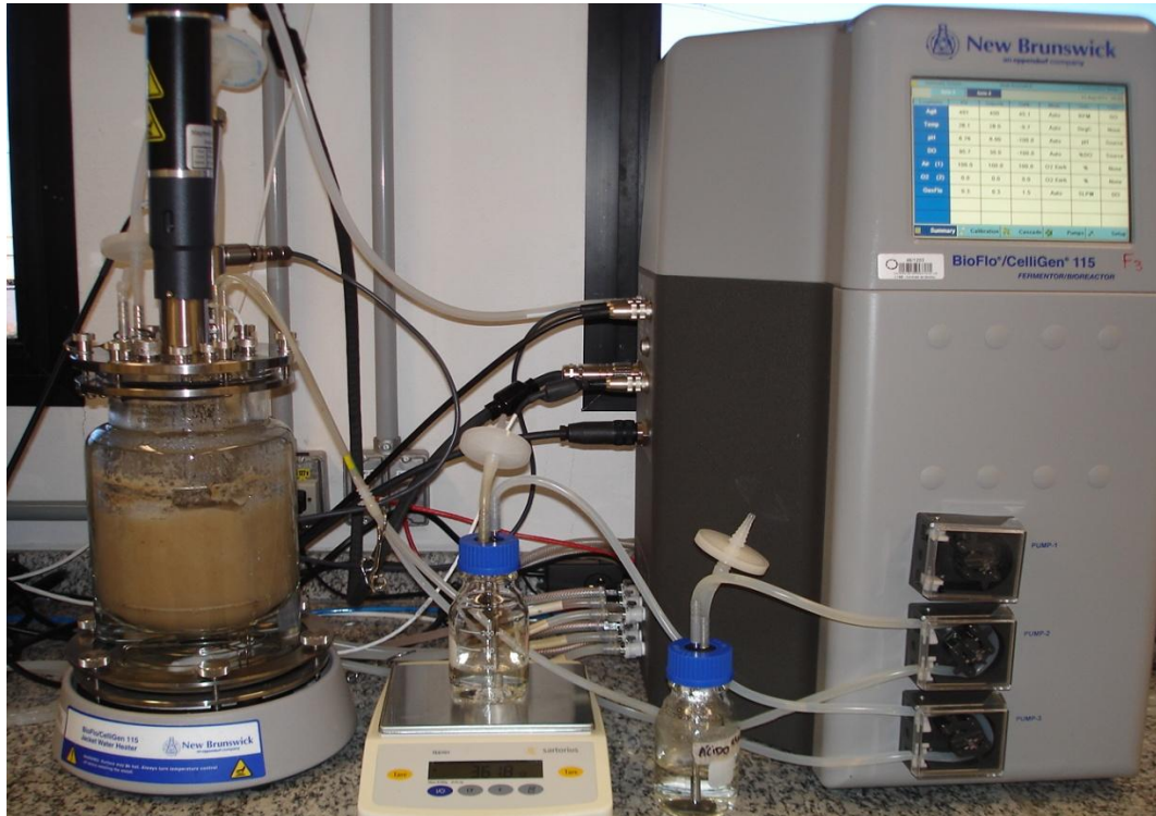
Figura 12. Biorreator com agitação mecânica da New Brunswick, modelo BioFlo/CelliGen 115.
