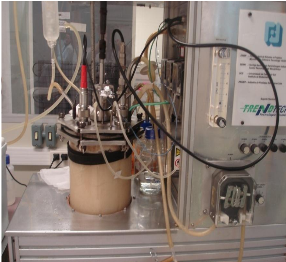
Figura 11. Biorreator com agitação mecânica, construído em parceria com a Universidade de Caxias do Sul e com o Senai/Mecatrônica.
