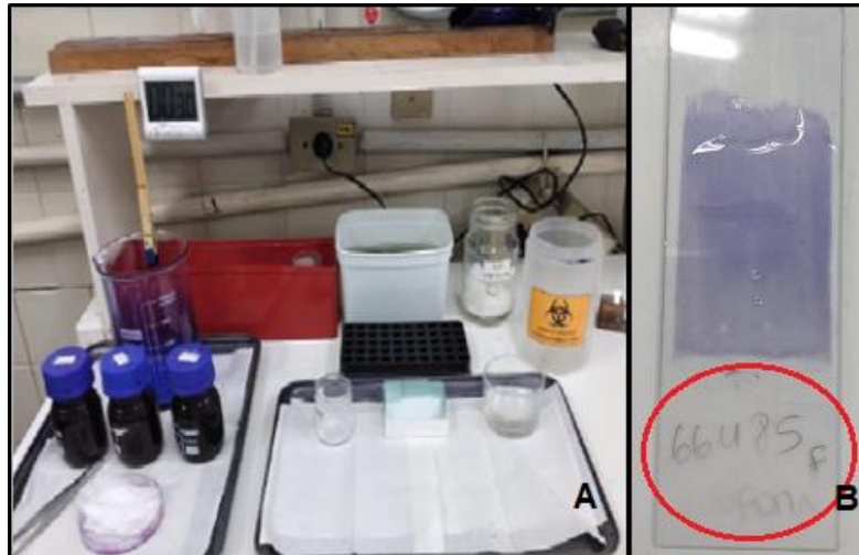
Figura 13 – Bancada onde eram confeccionados os esfregaços sanguíneos. A) Bancada com todos os materiais para confecção dos esfregaços sanguíneos; B) Esfregaço sanguíneo identificado (círculo vermelho) com código da ficha e espécie do animal.
