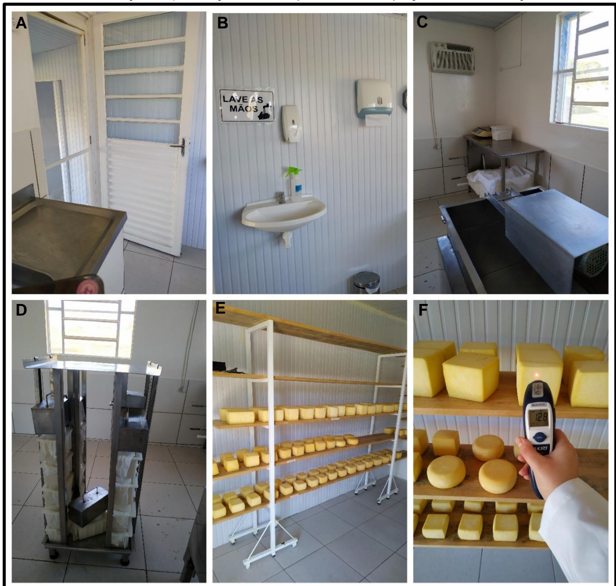
Figura 7 – A) Entrada da sala de processamento; B) Barreira sanitária interna; C) Tanque de processamento; D) Formas de imprensar; E) Sala de maturação; F) Aferição de temperatura das peças em maturação
