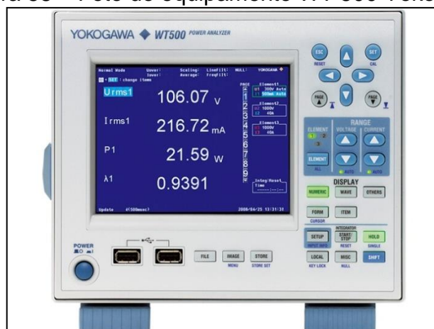
Figura 58 – Foto do equipamento WT 500 Yokogawa
