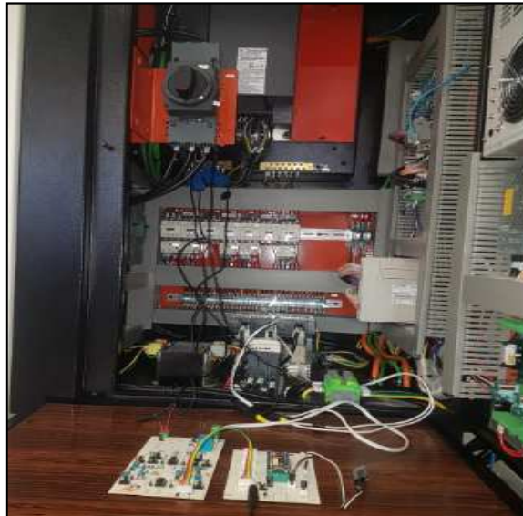
Figura 40 – Placa de aquisição de dados conectada na máquina.
