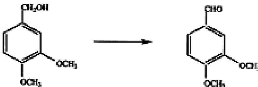
**Figura 5. Oxidação do álcool veratrílico a aldeído.**
