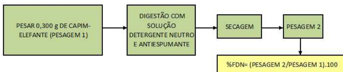
Figura 19. Esquema do método de determinação de FDN do capim-elefante.
