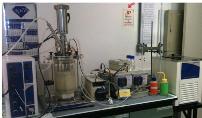
**Figura 8** - Biorreator de agitação mecânica Tecbio, Tecnal.
