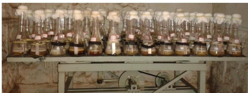
**Figura 6** - Frascos em agitador recíproco para cultivo submerso de *Aspergillus oryzae*.
