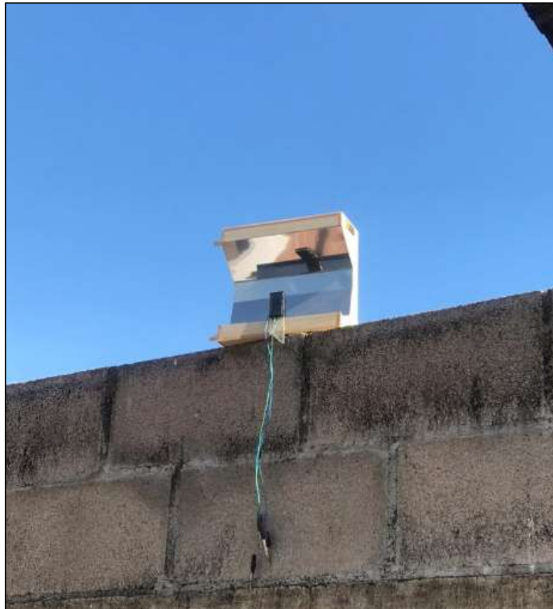
Figura 29 - Posicionamento do concentrador para teste elétrico em 90^\circ
