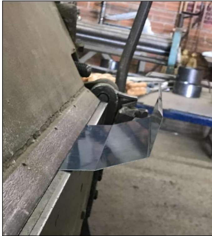
Figura 24 - Procedimento de dobra do perfil concentrador
