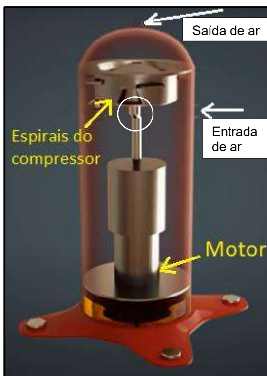
Figura 5 - Interior do compressor tipo Scroll
