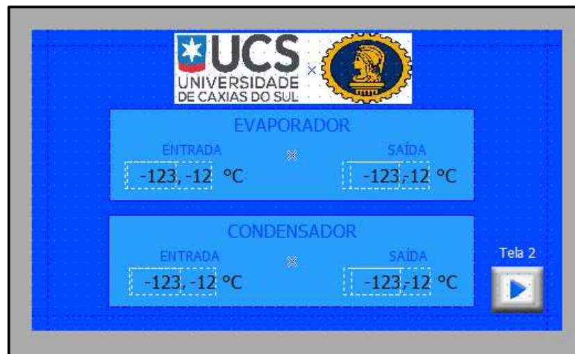
Figura 29 - IHM visualizada através do software
