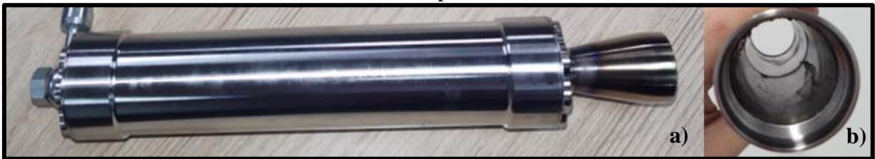
Figura 26 - Câmara de combustão após teste estático não monitorado a) exterior da câmara b) Interior da câmara de combustão após teste estático não monitorado
