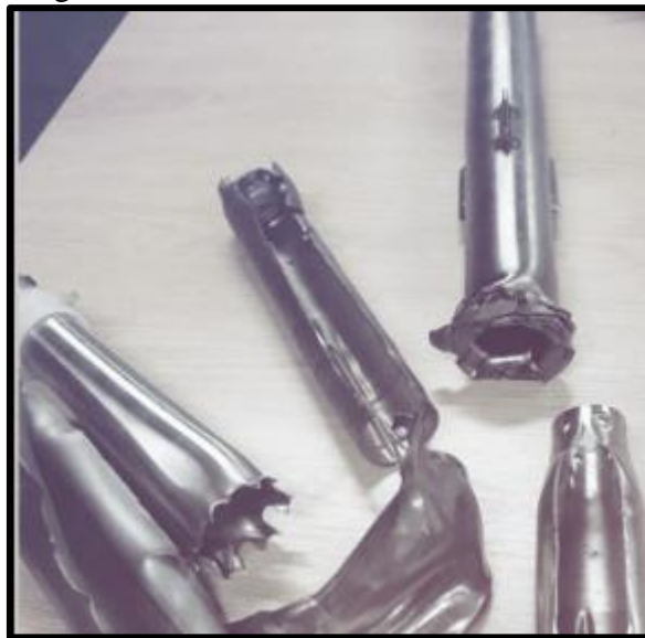
Figura 10 – Falha em câmara de combustão
