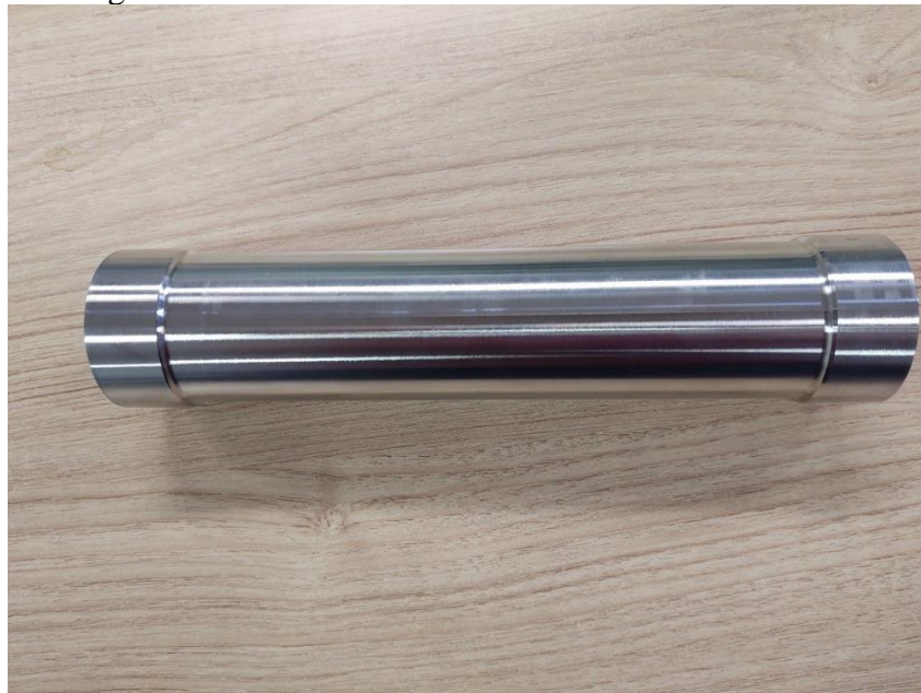
Figura D-2 – Câmara de combustão utilizada nos testes
