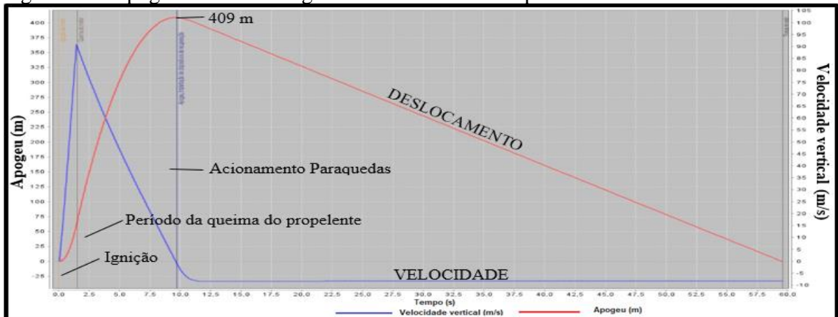
Figura 28 – Apogeu teórico do foguete com a curva de empuxo do teste estático monitorado 5
