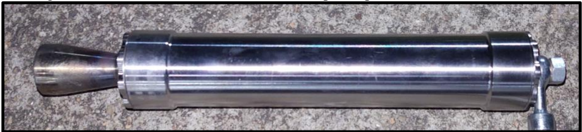
Figura 27 – Câmara de combustão ao centro após o quinto teste estático monitorado
