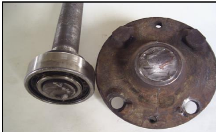
Figura 17 – Exemplo de quebra de semieixo
