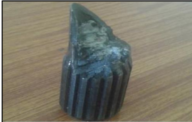
Figura 3 – Exemplo de quebra de semieixo no estriado
