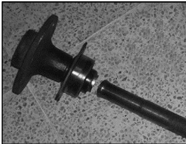
Figura 4 – Exemplo de quebra de semieixo após rolamento
