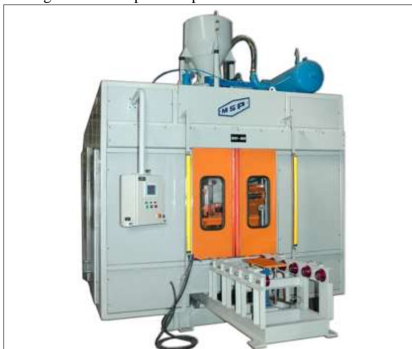
Figura 9 - Exemplo de sopradora de moldes em cold box
