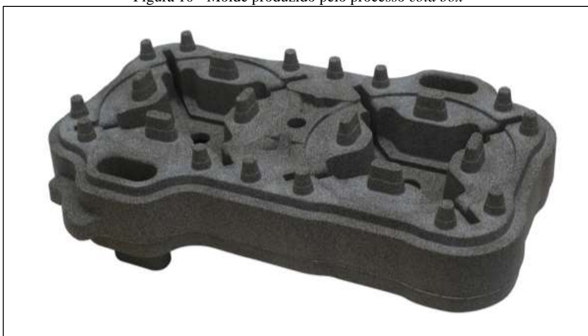
Figura 10 - Molde produzido pelo processo cold box
