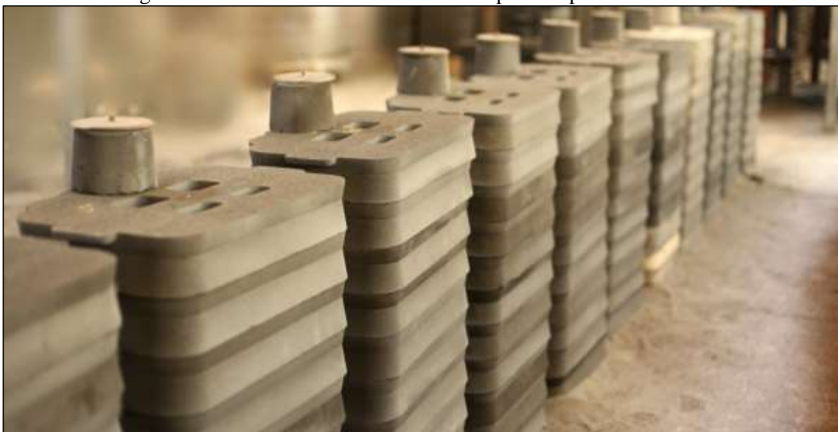
Figura 11 - Moldes montados em árvores prontos para o vazamento
