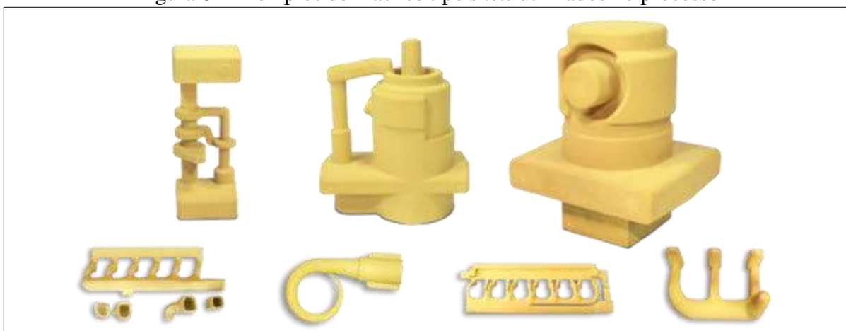
Figura 8 - Exemplos de machos tipo shell utilizados no processo
