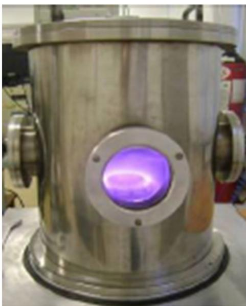
**Figura 23 – Equipamento de nitretação e oxidação a plasma do LESST.**
