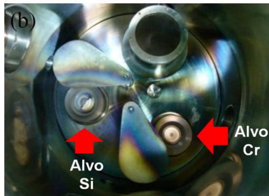
Figura 11: Vista do interior da câmara, indicando o posicionamento dos alvos.
