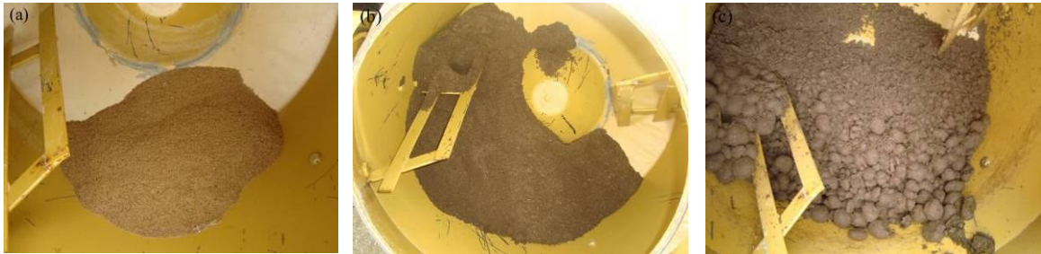
Figura 24: Etapas de preparação do solo simulado na betoneira: (a) areia grossa, (b) terra e (c) esterco de cavalo.
