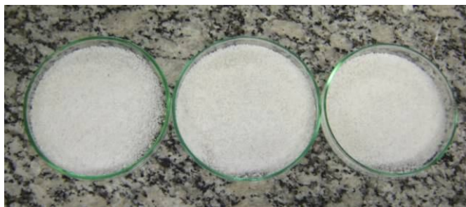
Figura 28: Aditivo pró-degradante após a trituração no moinho criogênico.
