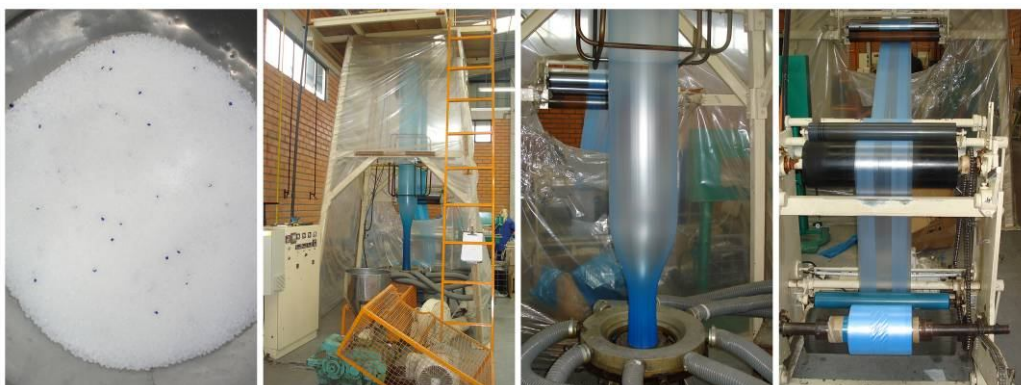
Figura 16: Processamento de extrusão por sopro dos filmes.
