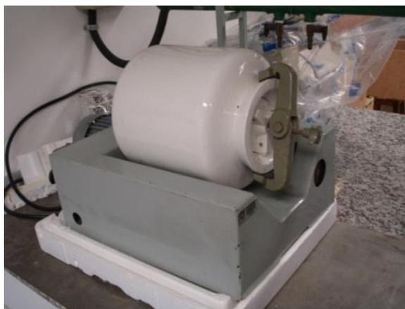
**Figura 29** – Moinho de bolas utilizado para processar as fibras de *Pinus taeda*.
