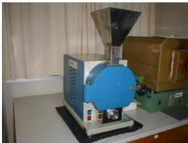
**Figura 28** – Moinho de facas utilizado para processar as polpas *kraft*.
