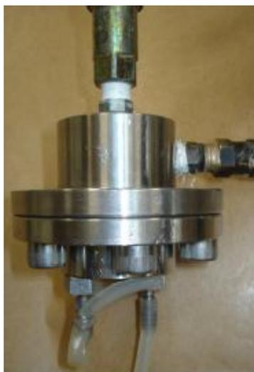
**Figura 33** – Cella de inox de ultrafiltração utilizada nos ensaios de permeação.
