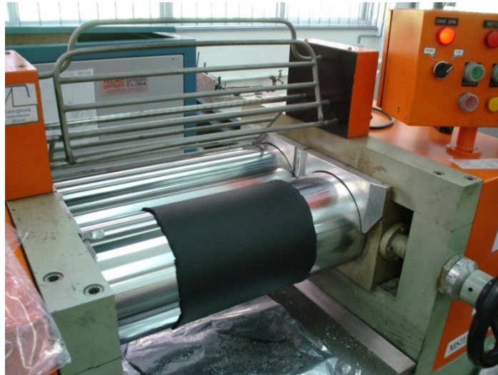
Figura 5: Incorporação dos componentes e aceleração das misturas no misturador de rolos.
