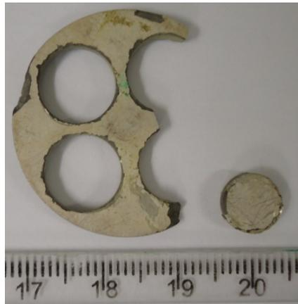
**Figura 21:** Transdutor piezoelétrico (PZT) utilizado na montagem do sistema de RUS.
