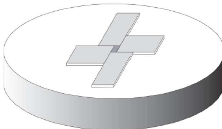
**Figura 29:** Esquema do dispositivo para polimento de amostras, com uma base e lâminas de vidro coladas a base com cola térmica *Crystalbond*<sup>®</sup>. Adaptado da referência [60].
