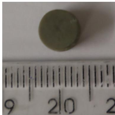
**Figura 26:** Amostra de  $ZrW_2O_8$  processada a 7,7 GPa por 2 horas após ser retirada de dentro do container de chumbo.
