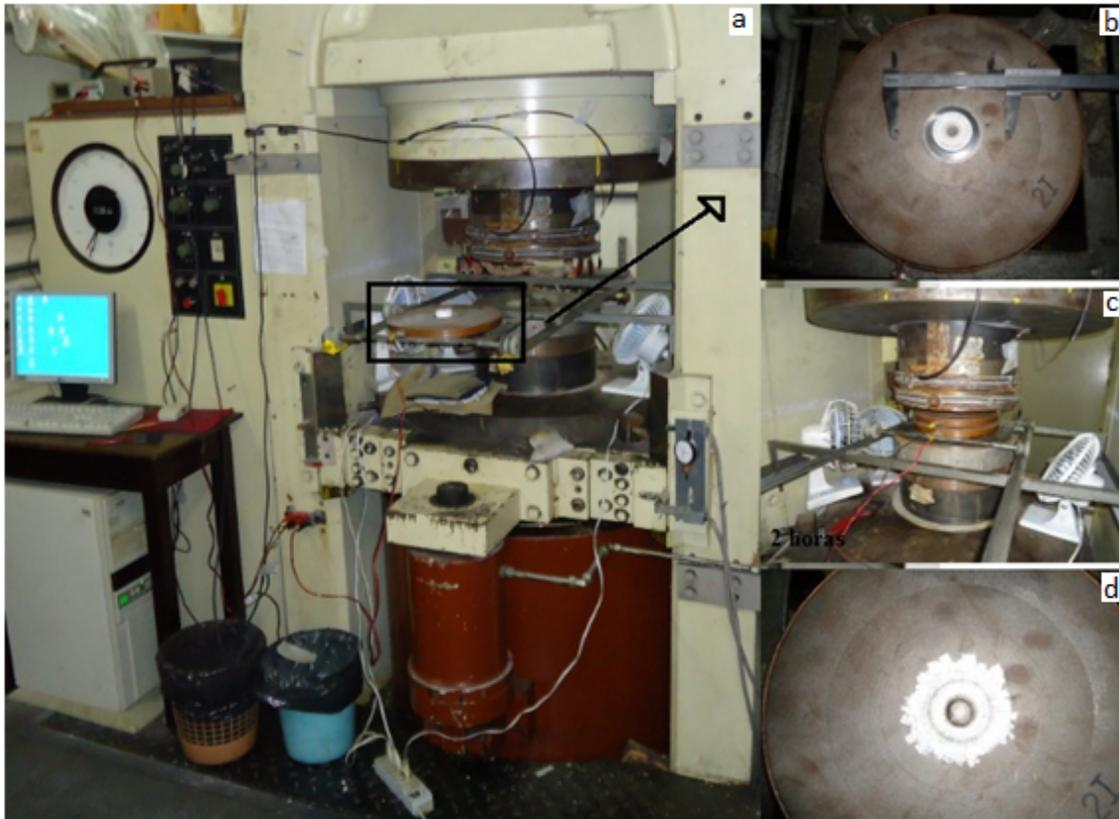
**Figura 25:** Em **a**, fotografia da prensa de 1000 tonf, em **b**, câmara toroidal e gaxeta cerâmica com contêiner de chumbo antes do processamento; em **c**, imagem do sistema durante o processamento (7,7 GPa por 2 horas) e em **d**, câmara toroidal com a gaxeta já deformada, após o processamento em altas pressões.
