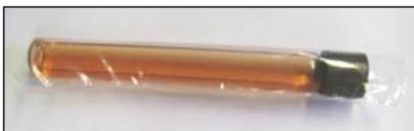
**Figura 31:** Foto do tubo com espuma envolvido com filme de PEBD aditivado.
