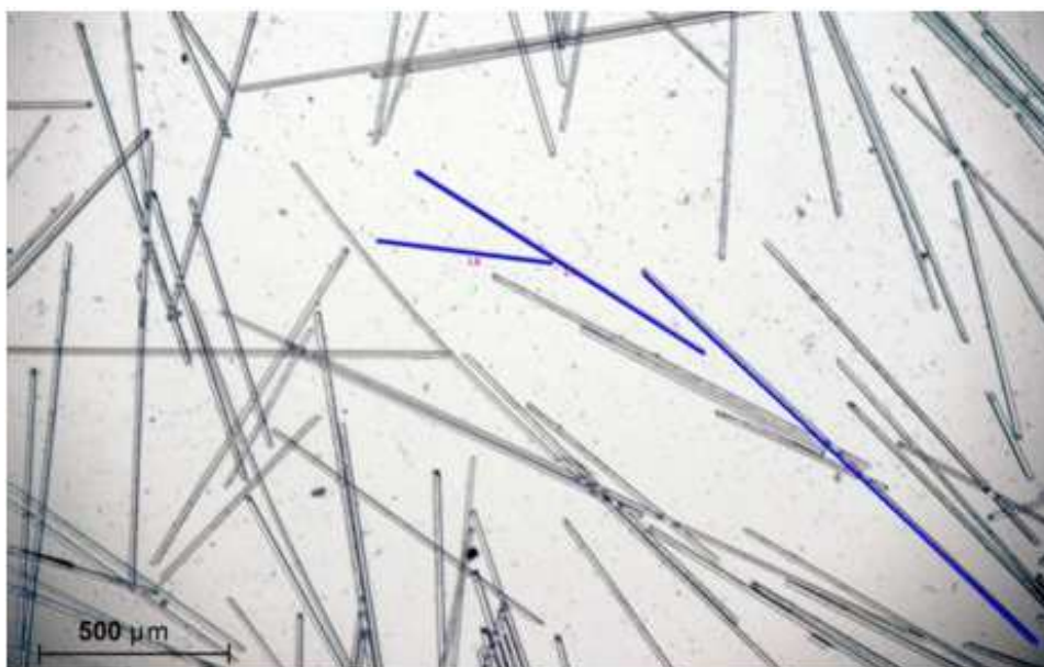
Figura 21 - Micrografia típica das fibras de vidro extraídas do compósito TRFL 40 %m fornecido pela RTP (aumento de 50 x).
