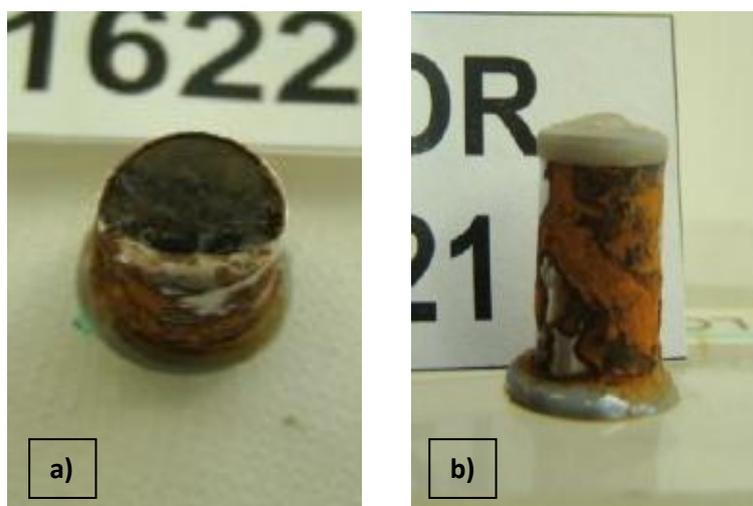
**Figura 30 - Sem tratamento a) corrosão no topo e b) na lateral.**
