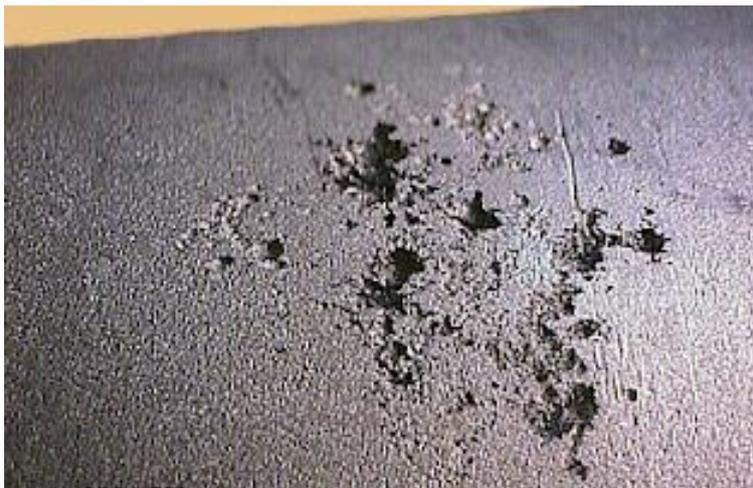
**Figura 2 - Detalhe da corrosão por pite**
