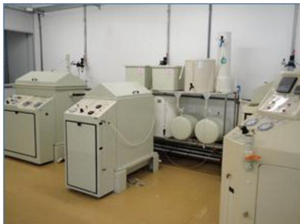
**Figura 17 - Câmaras utilizadas para ensaios de névoa salina [55]**
