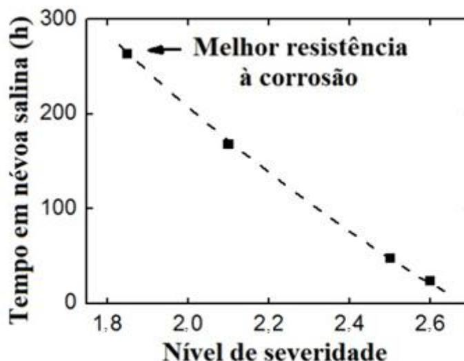
**Figura 39 - Nível de severidade em função do tempo de resistência em névoa salina**
