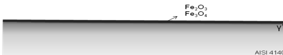
Figura 72 - Mecanismo de desgaste para o aço AISI 4140 nitretado em EHC.
