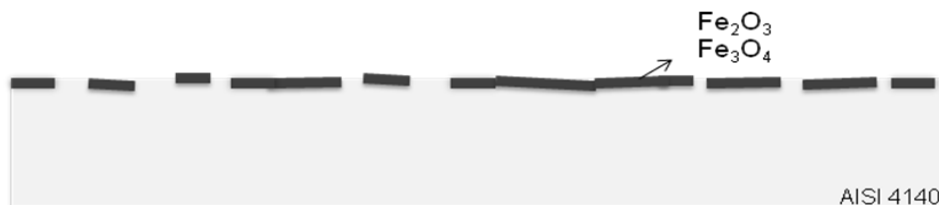
Figura 71 - Mecanismo de desgaste para o aço AISI 4140 temperado e revenido ensaiado em EHC.
