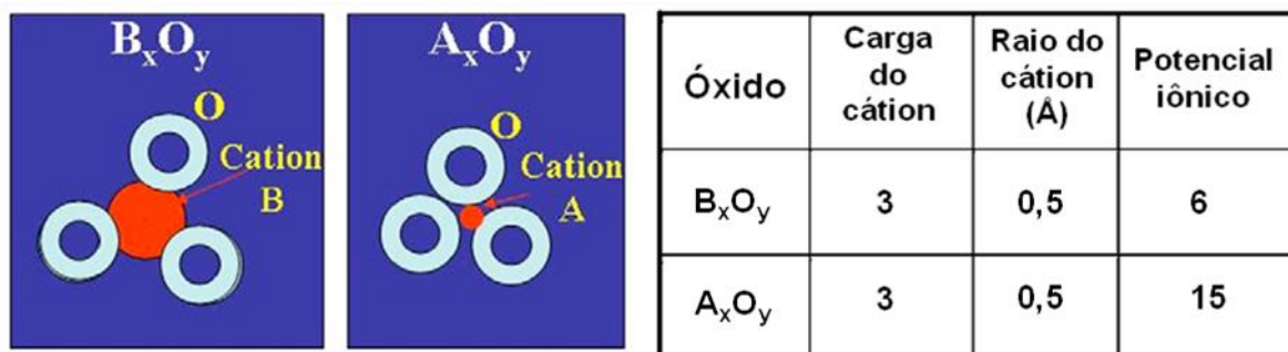
Figura 10 - Esquema ilustrativo do modelo cristalino químico baseado no potencial iônico [37].
