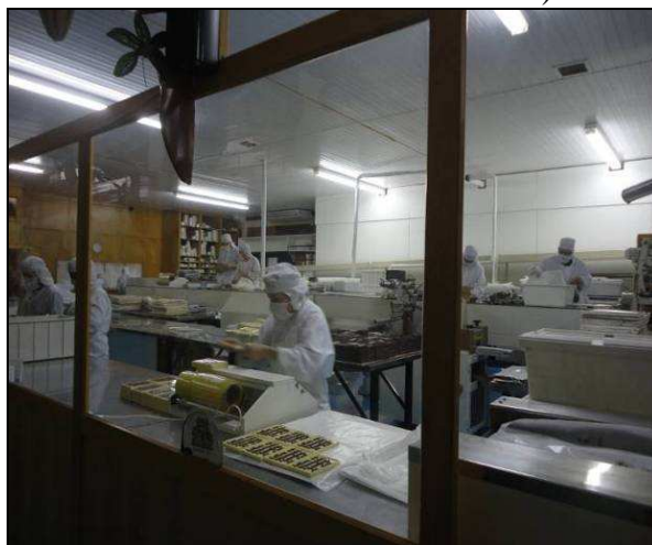
Figura 35 – Fábrica da empresa Florybal: a figura destaca uma linha de produção ao fundo, mas ao mesmo tempo o desenvolvimento de uma atividade artesanal (a embalagem e a escrita das barras feitas manualmente)
