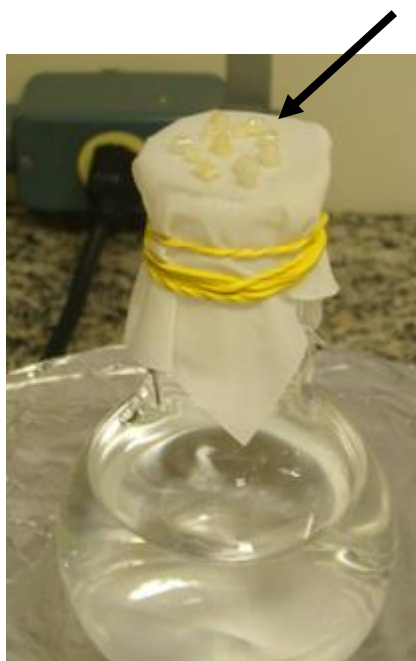
Figura 30 Ensaio de inchamento em balão contendo HCl e com alguns pellets de PA66 sobre tela de poliéster.
