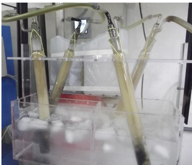
Figura 21: Borbulhadores evidenciando a formação dos gases de pirólise.
