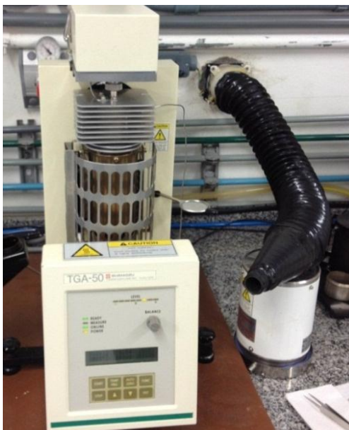
Figura 12: Balança Termogravimétrica utilizada nos ensaios.
