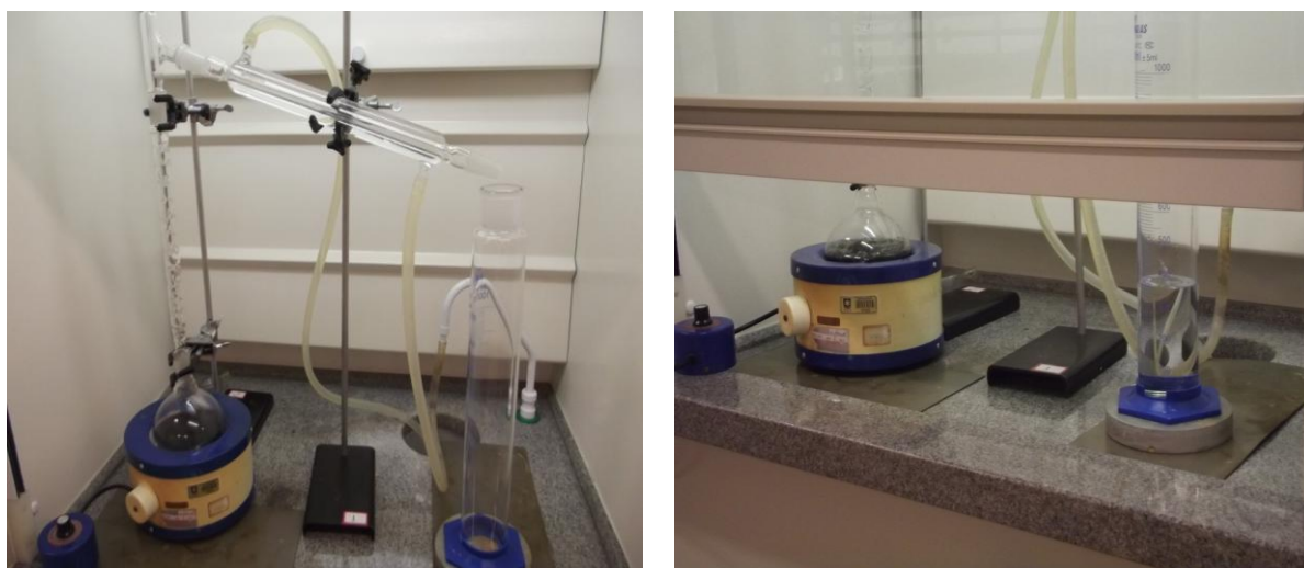
Figura 22: (a) Início do processo de destilação. (b) Formação do destilado.
