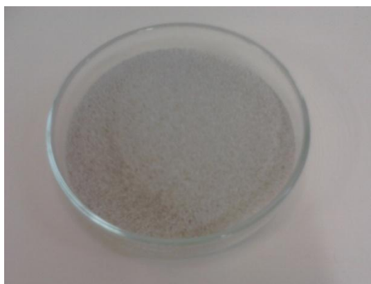
Figura 8: AIR utilizada como suporte do leito fluidizado.
