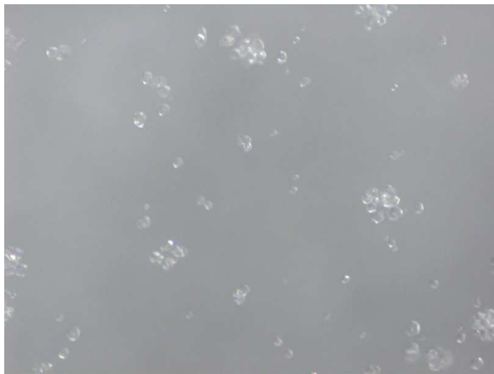
Figura 22: Micrografia (MO) durante o processo de gelatinização do amido de milho eterificado a 40°C (20x).
