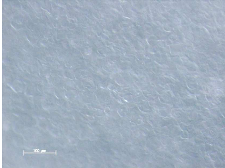
Figura 26: Micrografia (MO) durante o processo de gelatinização do amido de milho eterificado a 80°C (20x).
