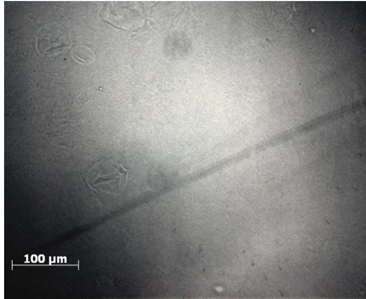
Figura 27: Micrografia (MO) durante o processo de gelatinização do amido de milho eterificado a 90°C (20x).
