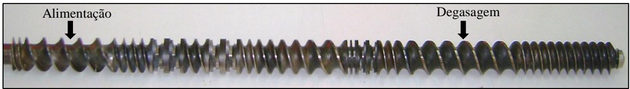
Figura 10: Perfil da rosca utilizada na extrusora dupla-rosca.
