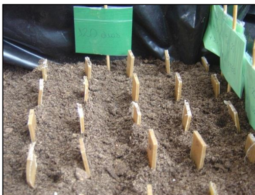
Figura 14: Disposição dos corpos de prova no solo simulado.
