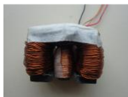
Figura 21. Exemplo de yoke / sensor utilizado para as medidas magnéticas de RB.
