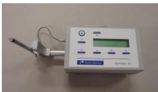
Figura 14. Equipamento utilizado para medida de rugosidade – Rugosímetro Taylor-Hobson do laboratório de novas Tecnologias de Produção da UCS.
