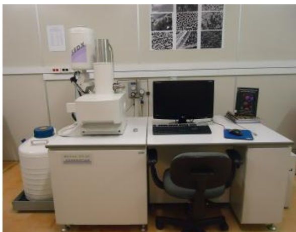
Figura 15. Imagem do Microscópio Eletrônico de Varredura utilizado do Laboratório .
