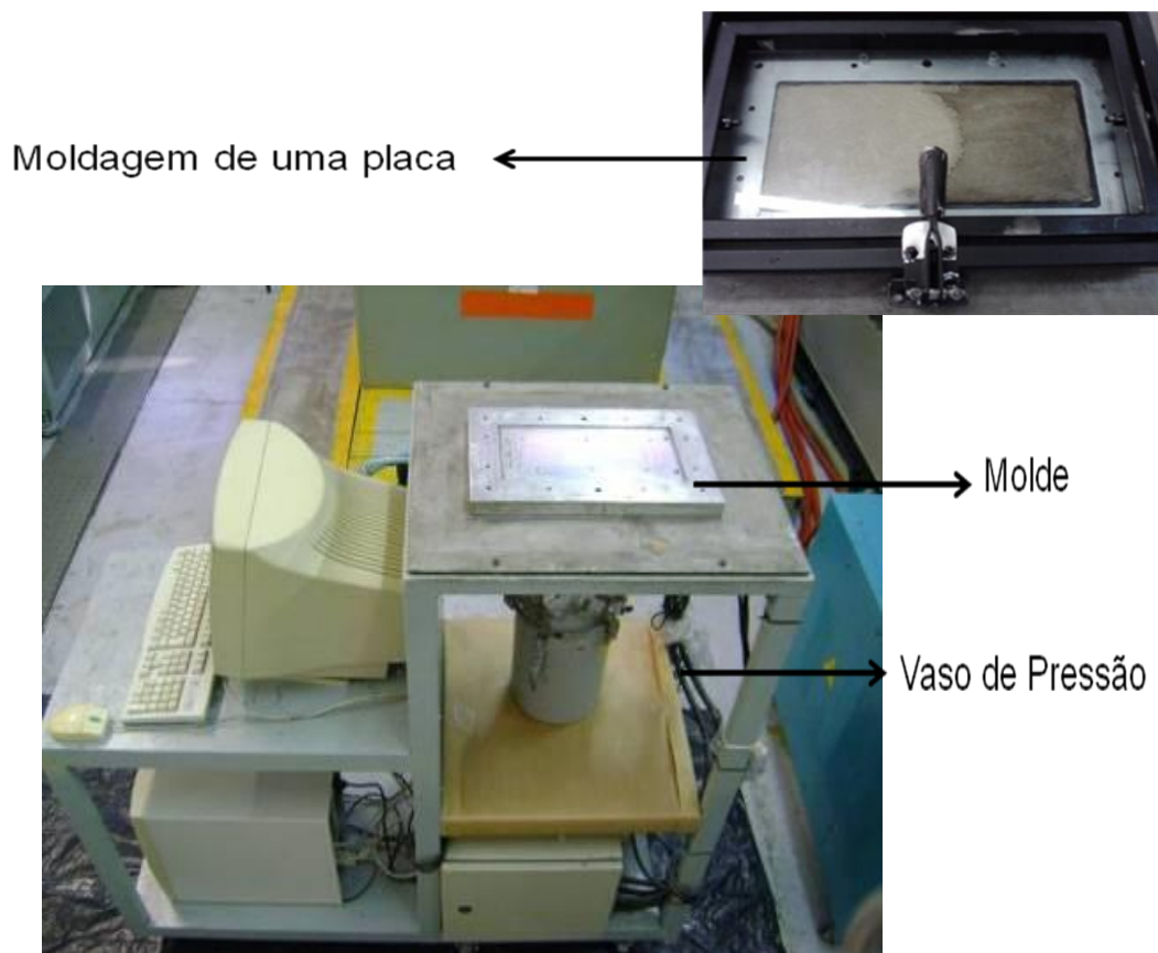
Figura 14. Moldagem por transferência de resina.
