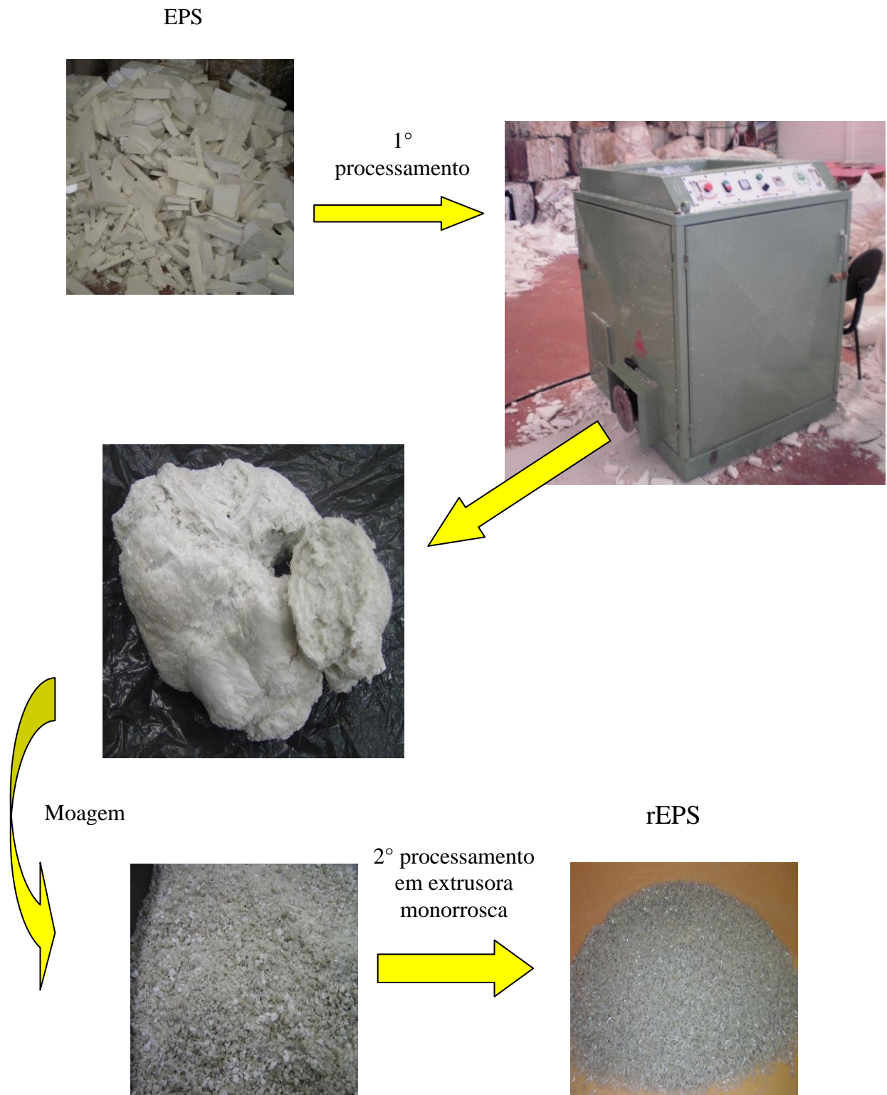
Figura 14. Processo utilizado para reciclagem do EPS.
