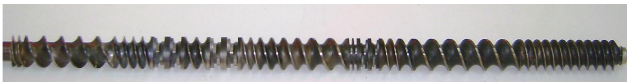
Figura 15. Perfil da rosca utilizada no processo de extrusão em duplarrosca.
