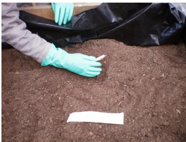
Figura 19. Teste de degradação do tecido de algodão no solo simulado.
