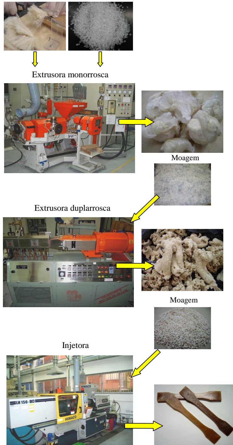
Figura 16. Sequência das etapas empregadas para obtenção dos compósitos.
