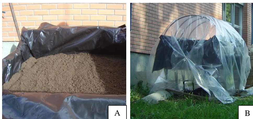
Figura 18. Estufa construída para o acondicionamento do solo simulado, (A) caixa para acondicionamento do solo e (B) cobertura plástica.
