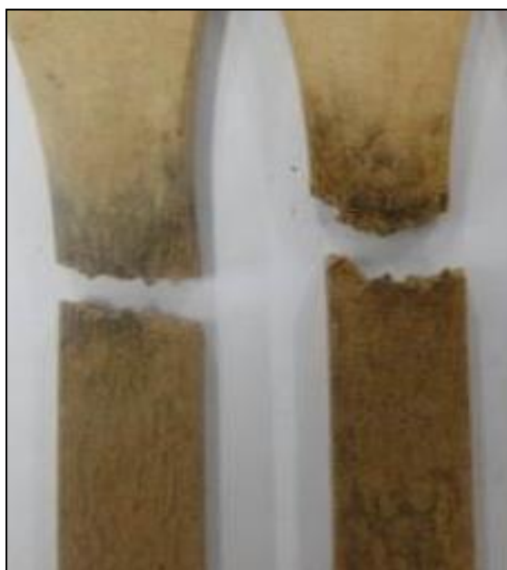
Figura 34 - Foto do corpo de prova tracionado de PLA/B 30M /T 5 /150 solo após 150 dias de exposição em solo simulado, ampliado.
