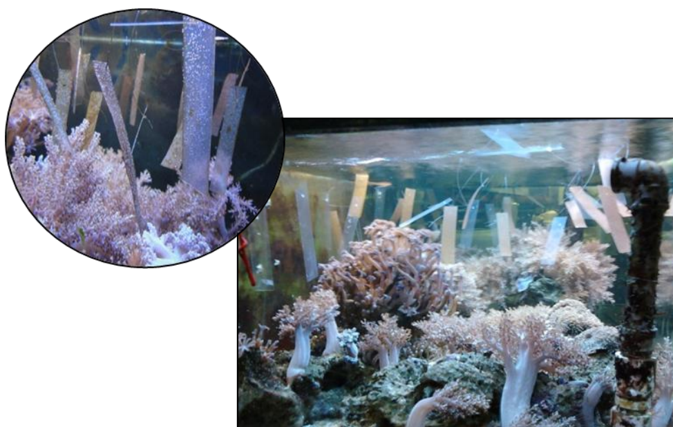
Figura 17 – Disposição dos filmes de PLA e dos compósitos em ambiente marinho simulado.
