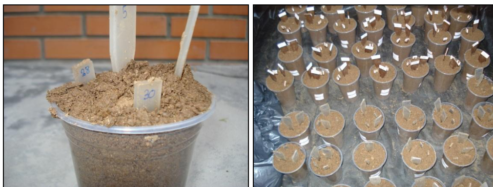
Figura 16- PLA e compósitos dispostos em solo simulado.
