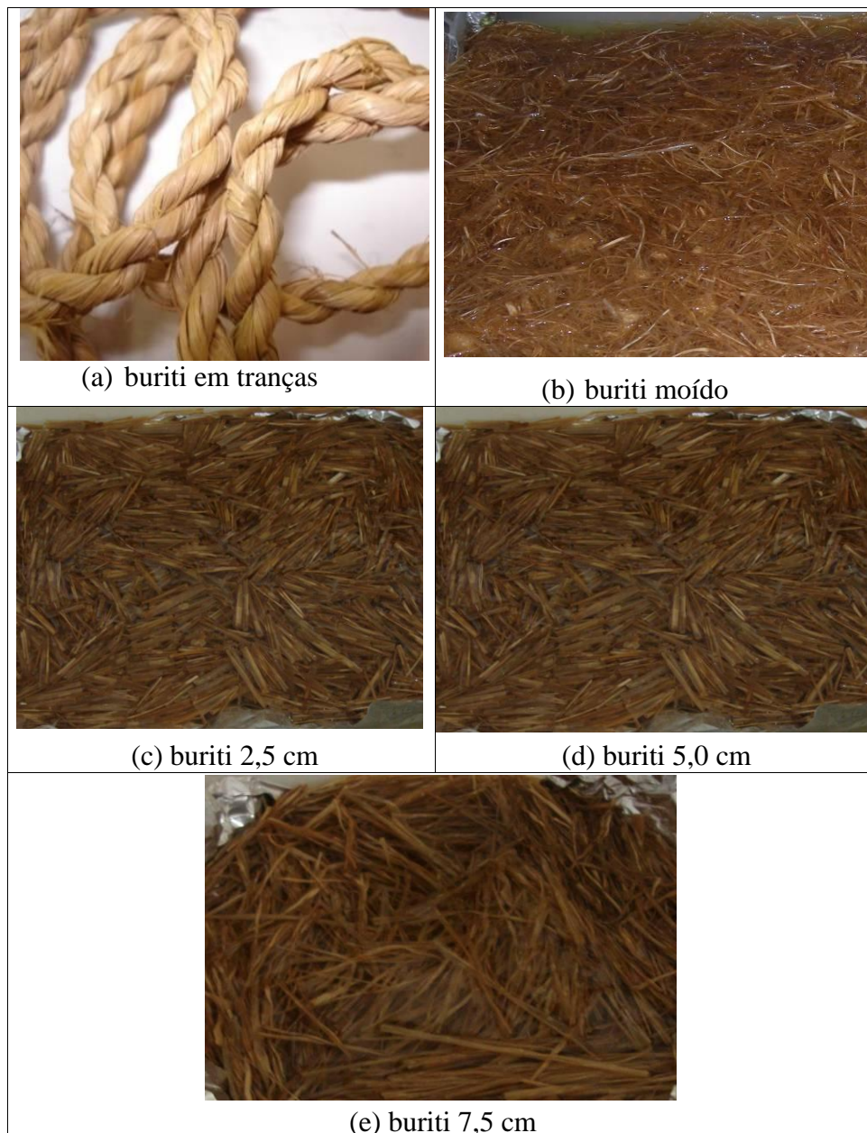
Figura 12 - Fibras de buriti (a) em tranças, (b) moída, (c) cortada com 2,5 cm, (d) cortada com 5,0 cm (e) cortada com 7,5 cm.
