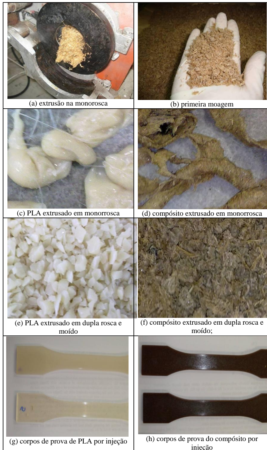
Figura 13 - Características visuais do material após (a) extrusão na monorrosca; (b) primeira moagem; (c) PLA extrusado na monorrosca; (d) compósito extrusado na monorrosca (e) PLA extrusado em dupla rosca e moagem (f) compósito extrusado em dupla rosca e moído; (g) corpos de prova de PLA por injeção; (h) corpos de prova do compósito por injeção.
