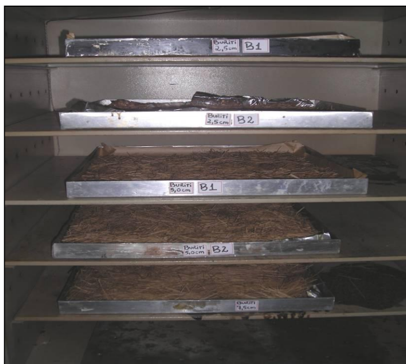
Figura 11 – Foto ilustrando a secagem das fibras na estufa com circulação de ar.
