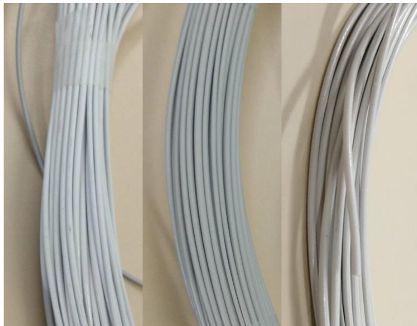
Figura 15 – Filamentos obtidos via extrusão alumina/PEBD (c/AE) (esquerda), alumina/ABS (c/AE) (centro) e alumina/PLA (c/AE) (direita).
